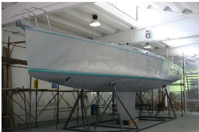
Una barca in alluminio di resistenza uguale a un paragonabile progetto in acciaio o vetroresina avrà un peso almeno del 20% inferiore.
